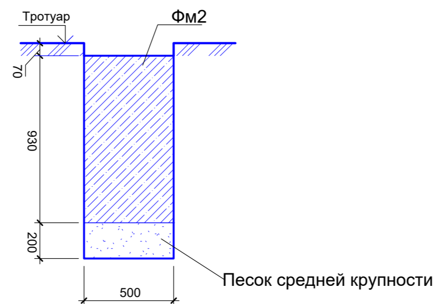
Фундамент под МАФ Фм2 Опалубка
